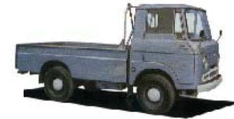
Adopto un motor diesel de inyección indirecta, una transmisión manual de 4 velocidades totalmente sincronizada, un sistema de frenado hidromaster estandarizado y en 1969 consiguió el numero uno de la cuota del mercado japonés.
