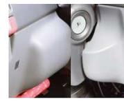
Los protectores de rodillas permiten absorber el impacto para resguardar de esta manera las piernas del conductor.
